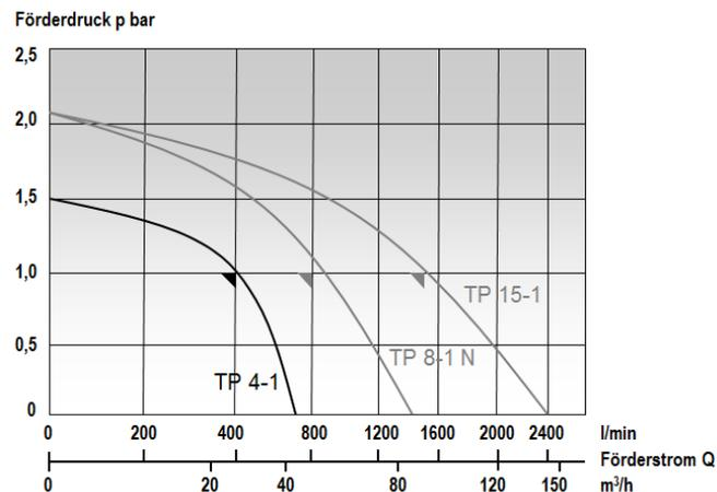
Q l/min, bei H m (Wassersäule), gültig für  $\rho = 1 \text{ kg/dm}^3$  und kinematische Viskosität  $\eta = 1 \text{ mm}^2/\text{s}$ .
